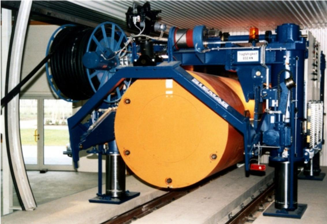
**Abb. 3.2** Einlagerungsvorrichtung für die Streckenlagerung von POLLUX®-Behältern, aus /GRS 11/
