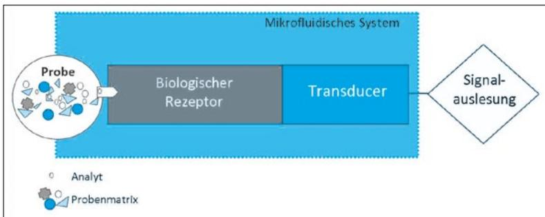
Abb. 3: Prinzipieller Aufbau eines Biosensors.
