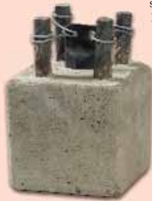
In Stahlbeton eingebauter RFID-Transponder © HARTING, Espelkamp
