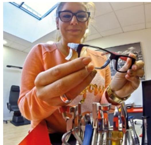
Dabei werden die Gestelle von den Optikern in der Werkstatt vermessen und die Daten digital auf die Schleifmaschine übertragen. Dann werden die Gläser passgenau für das Gestell formgerandet. Gleich nach dem Einsetzen der Gläser in die Fassung erfolgt die individuelle Anpassung am Kopf. Wer nicht warten will, der geht einen Kaffee trinken, bis die Sehhilfe fertig ist.
