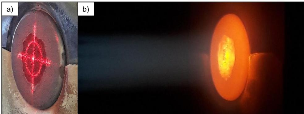
Abbildung 6.45: Brennerprobe a) nach Einbau und b) während der thermischen Belastung
