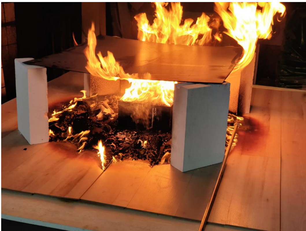
Abbildung 6-28: Keine Brandausbreitung auf nicht durch „Reflexionstisch“ überdeckte Bereiche
