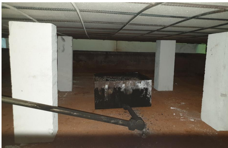
Abbildung 6-13: Position des Brenners unter den Matratzen (Konfiguration „Doppelbett“)
