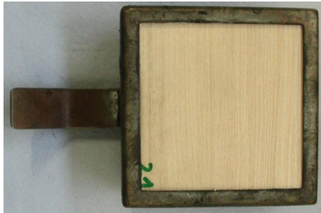
Abbildung 5-11: Cone-Kalorimeter-Probe des Laminats im Probenhalter
