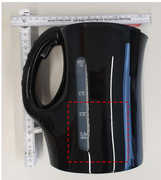
Abbildung 5-8: Ansicht eines Wasserkochers mit Sägekanten (li.), Cone-Kalorimeter-Probe des Wasserkochers im Probenhalter (re.)
