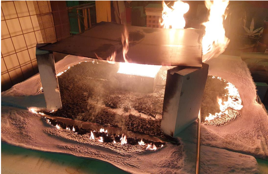
Abbildung 6-25: Kreisförmiges Ausbreiten der Flammen beim Teppich-Großversuch nach etwa 30 Minuten
