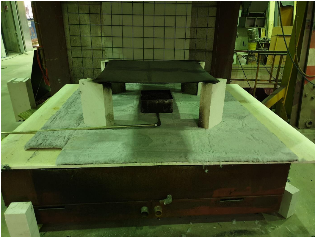
Abbildung 6-22: Versuchsaufbau des Großversuches mit dem Teppich bei indirekter Beflammung durch „Reflexionstisch“
