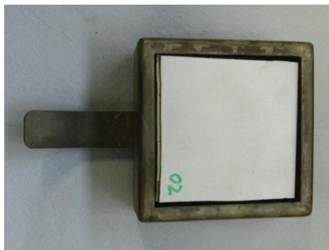
Abbildung 5-6: Cone-Kalorimeter-Probe des Laptops im Probenhalter
