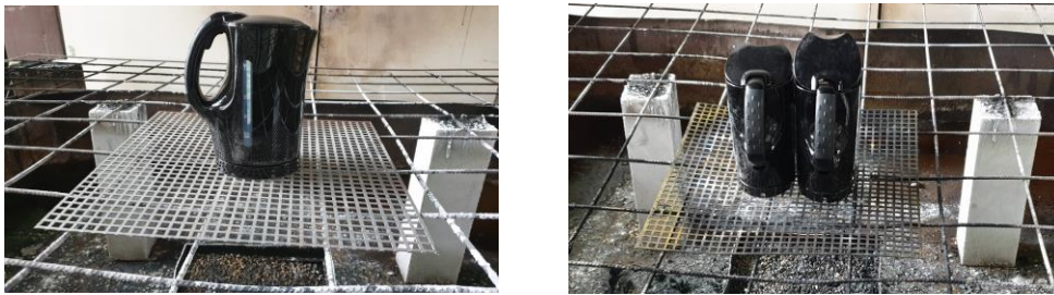
Abbildung 6-16: Versuchsanordnung des Großversuchs mit dem Wasserkocher, einzeln (li.) und mit erhöhtem Probenmasse (re.)
