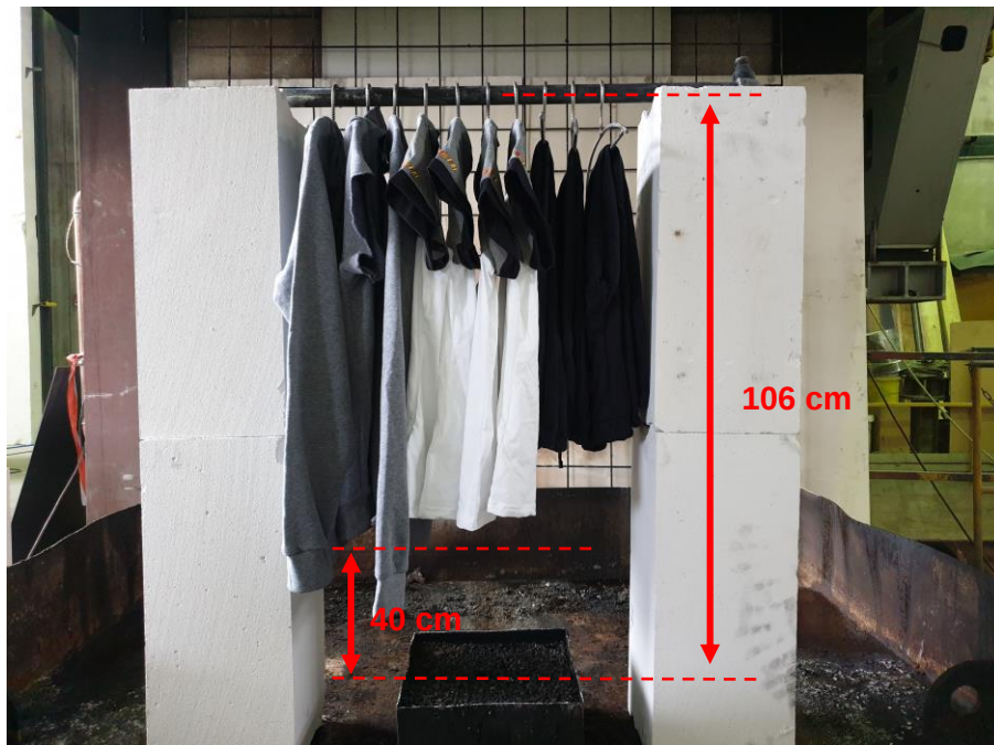
Abbildung 6-2: Untersuchung der Kleidung auf einer Kleiderstange über dem Brenner
