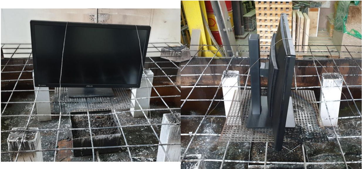
Abbildung 6-5: Versuchsanordnung des Großversuchs mit dem Computerbildschirm
