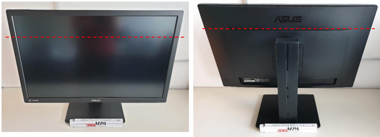
Abbildung 5-2: Vorder- und Rückseite des untersuchten Computerbildschirms, rote Sägekanten für die Probenherstellung
