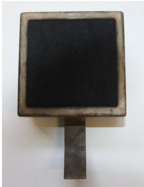
Abbildung 5-4: Dreilagige Cone-Kalorimeter-Probe der Kleidung im Probenhalter
