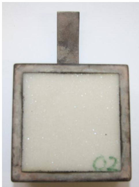
Abbildung 5-7: Cone-Kalorimeter-Probe der PUR-Matratze im Probenhalter
