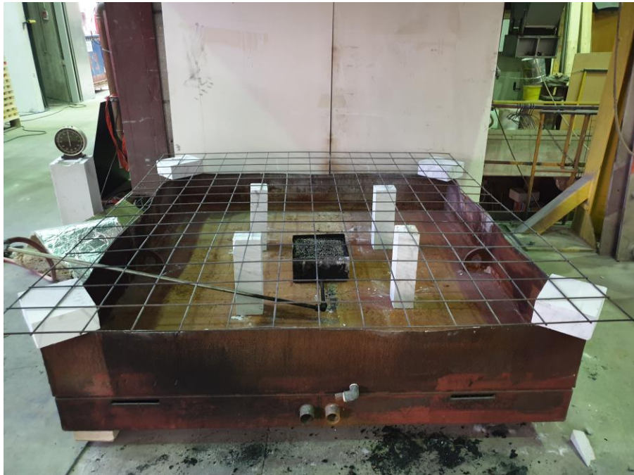
Abbildung 6-1: Versuchsaufbau zur Untersuchung der Alltagsgegenstände bei direkter Beflammung von unten
