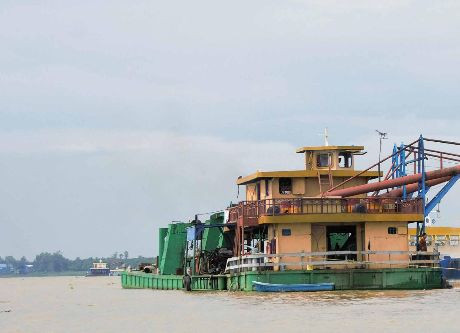
*Sandabbau mit hydraulischen Saugpumpen und direkte Beladung eines Lastkahnens entlang des Mekong, Kambodscha (Foto: Robert John).*
