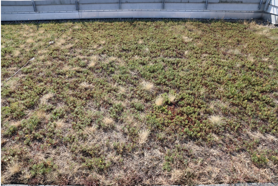
Abbildung 20 Dachbegrünung mit Substrat A (max. Wasserkapazität 65 %) aufgenommen am 16.08.2018 in Berlin (© Susanne Herfort)
