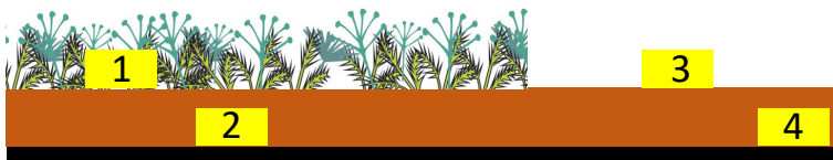
Abbildung 25 Untersuchungen zum Temperaturverhalten auf einer extensiven Dachbegrünung mit und ohne Fehlstellen
