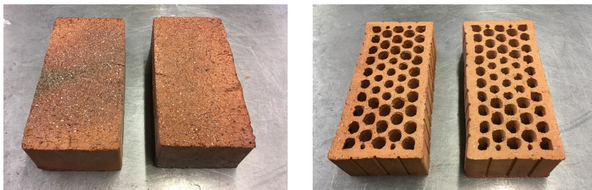
Abb. 3-1 Normalformatige Voll- und Hochlochziegel für die Versuchsdurchführung
