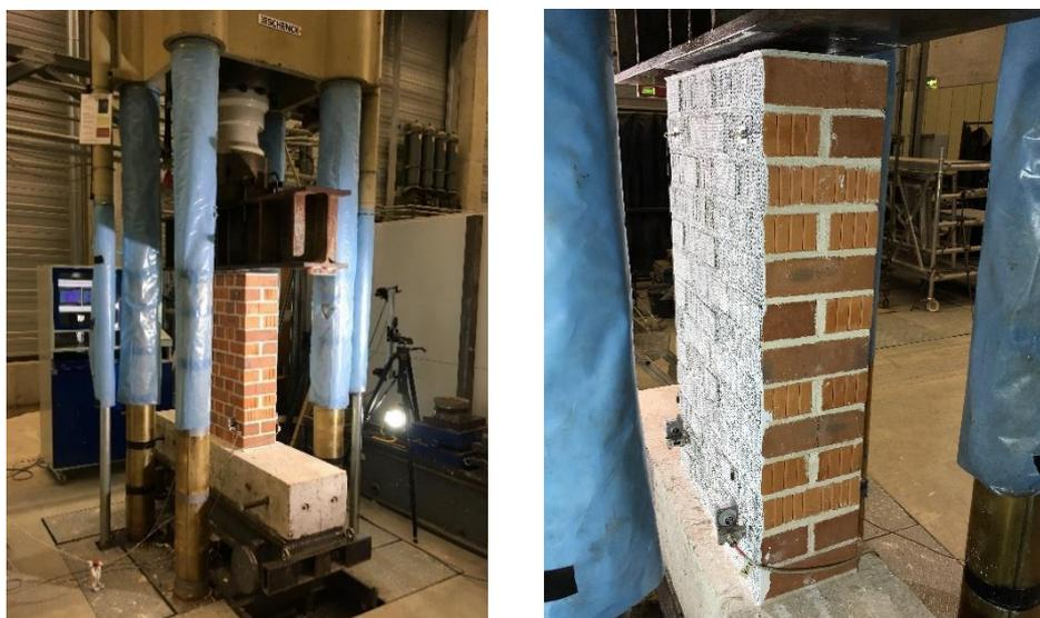
Abb. 3-11 Versuchsaufbau für Wand KV-50-1 (beispielhaft)
