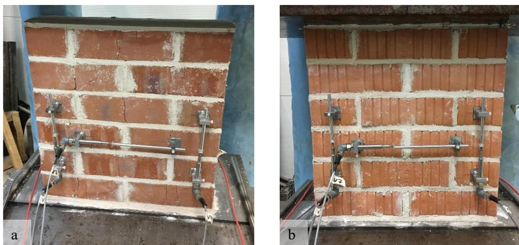
Abb. 3-7 RILEM-Prüfkörper zur Ermittlung der Mauerwerksdruckfestigkeit (a: Vollziegelmauerwerk, b: Lochziegelmauerwerk)
