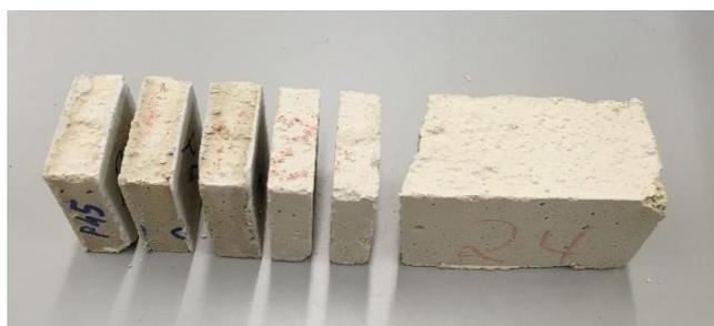
Abb. 3-4 Aus normativen Mörtelprismen herausgesägte Probekörper für eine Prüfung in Anlehnung an DIN 18555-9 (2019)
