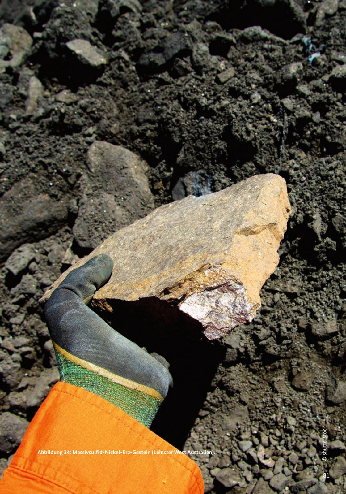
Abbildung 34: Massivsulfid-Nickel-Erz-Gestein (Leinster West Australien).
