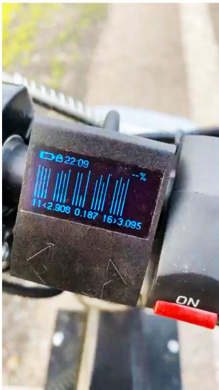
Во время первой экспериментальной поездки одна из ячеек просела, в следствие чего батарея разрядилась
