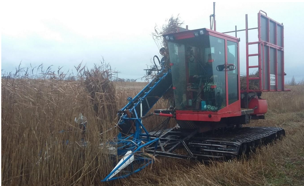
Abb. 3: Winterliche Schilfmahd in Bunden mit raupenbasierter Technik. Foto: F. Birr, 12/2018.
