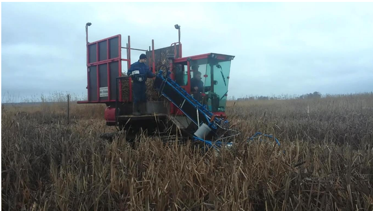
Abb. 4: Winterliche Mahd eines natürlich etablierten Rohrkolbenröhrichtes mit kettenbasierter Technik bei Anklam, Mecklenburg-Vorpommern. Foto: F. Birr, 12/2018.
