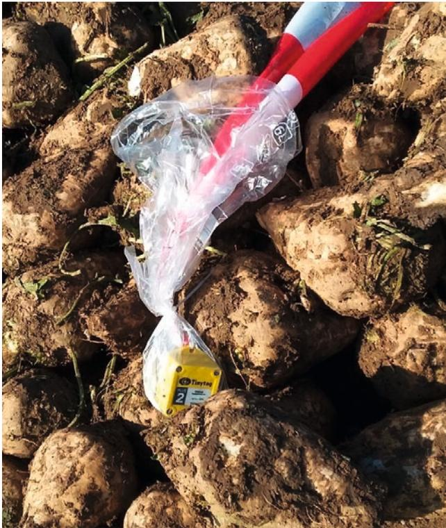
**Bild 14:** Die Datenlogger wurden geschützt, durch Absperrband kenntlich gemacht und zwischen dem Rübematerial positioniert
