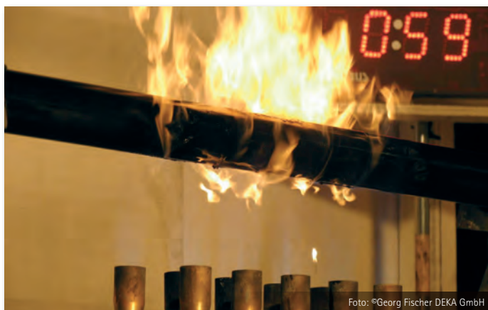
Brandtest an einem Kunststoffrohr nach IMO 753 Standard
