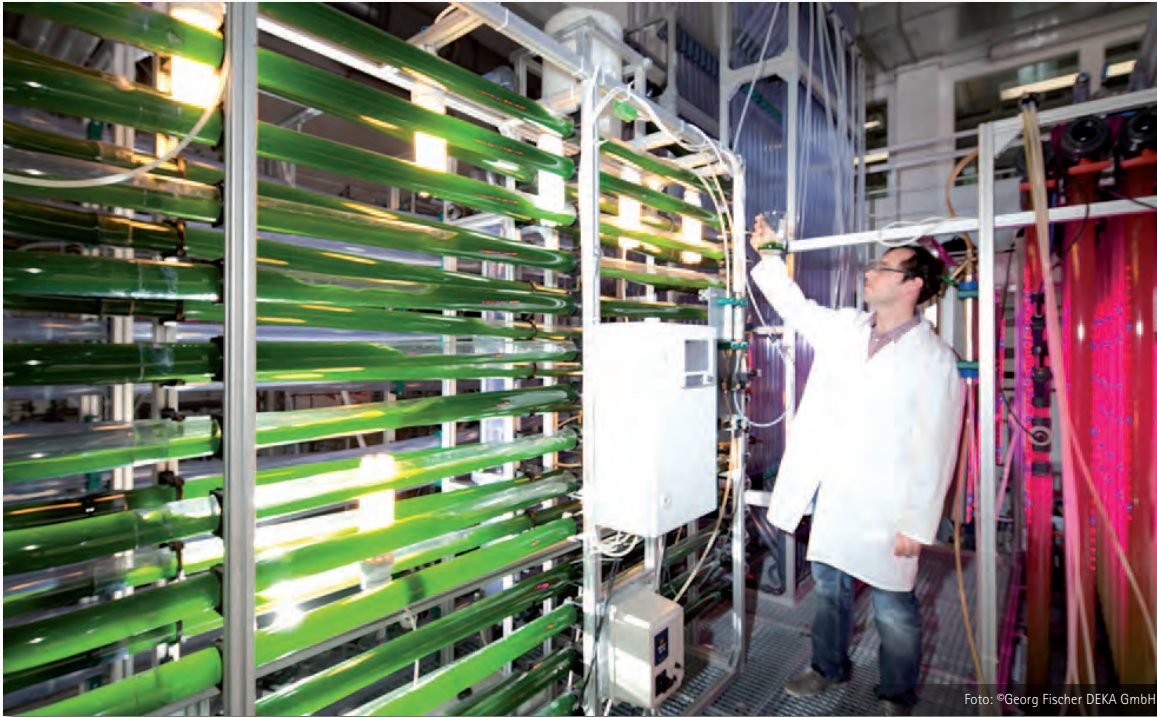
Bioreaktoren aus Kunststoffrohren zur Kultivierung von Algen als Rohstoff für die Kosmetikindustrie, Nahrungsmittelproduktion oder zur Herstellung von Biokraftstoff
