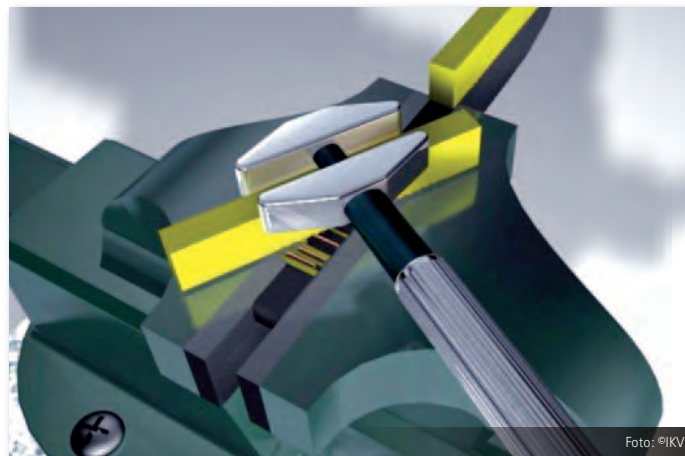
Torsionsscherversuch zur Charakterisierung der mechanischen Eigenschaften von Heizwendel- und Heizelementmuffen-Schweißverbindungen
