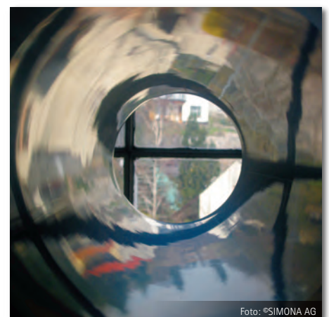
Ein Ergebnis der Nukleierung ist eine geringere Oberflächenrauigkeit und somit eine glattere Rohrrinnenfläche – Vorteile für die Hydraulik.
