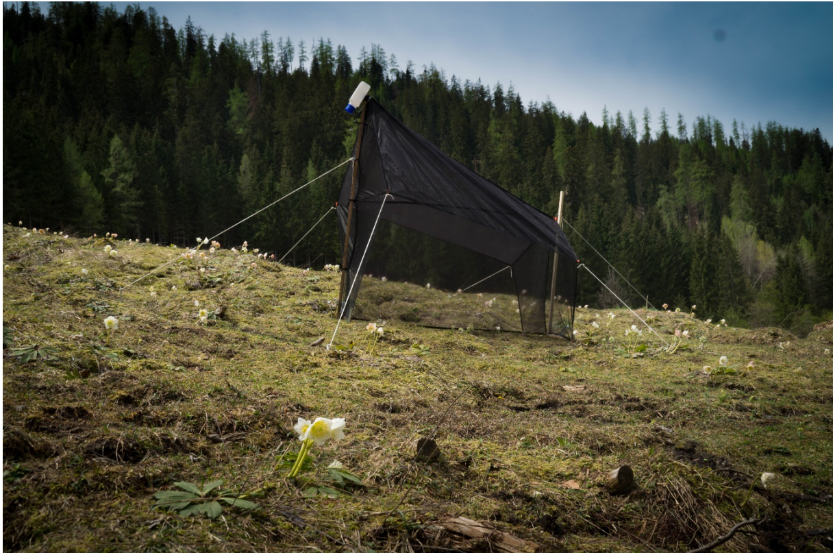
Abb. 1: Malaisefalle im Nationalpark Berchtesgaden. Die Identität der gefangenen Insekten wird mit DNA-Metabarcoding bestimmt. Foto: Janika Kerner
