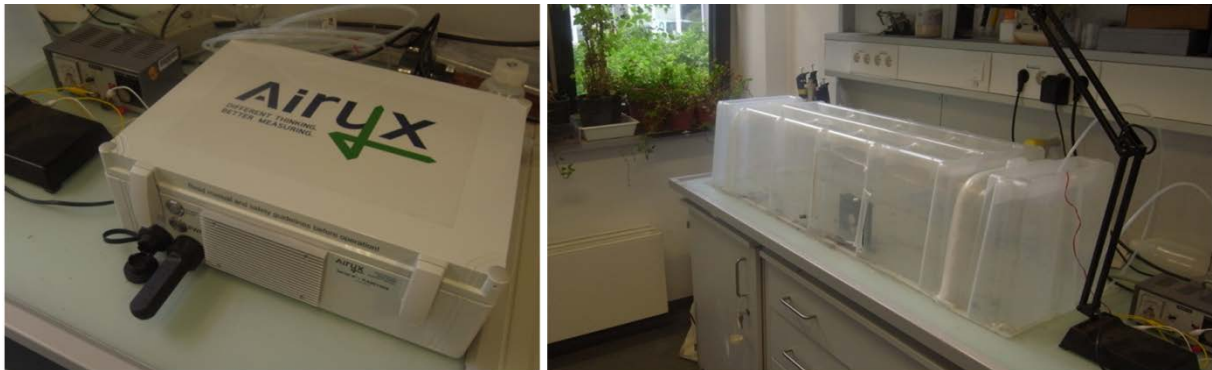
Abb. 4: Die linke Aufnahme zeigt das \text{NO}_2 -Messgerät („ICAD“ der Firma Airyx, Heidelberg); im rechten Bild ist der „Pflanztunnel“ zu erkennen, in dem in Durchfluss-Experimenten die Adsorptions- und Absorptionspotentiale diverser eingebrachter Pflanzen untersucht wurden.
