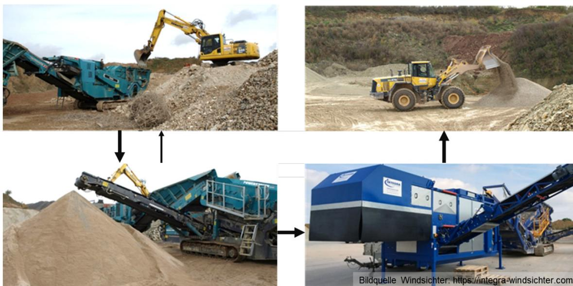
**Abbildung 6.** Schritte der Aufbereitung in der mobilen Anlage: Aufgabe (Bagger), Brechen (Prallbrecher) Sieben, Klassieren (Windsichter) und Transport (Radlader). Quelle: Fotografin Dilan Glanz, Integra Windsichter.
