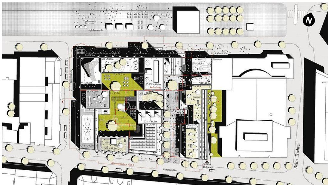
Abbildung 46 – Städtebauliches Konzept mit Einteilung in Blockrand (links) und Zeile (rechts), dazwischen Quartiersgasse, vielfältige Freiräume und Dachnutzungen. Ohne Maßstab (© Arge NL Architects und BeL Sozietät für Architektur, Bayrische Hausbau GmbH und Co. KG 2015)<sup>16</sup>
