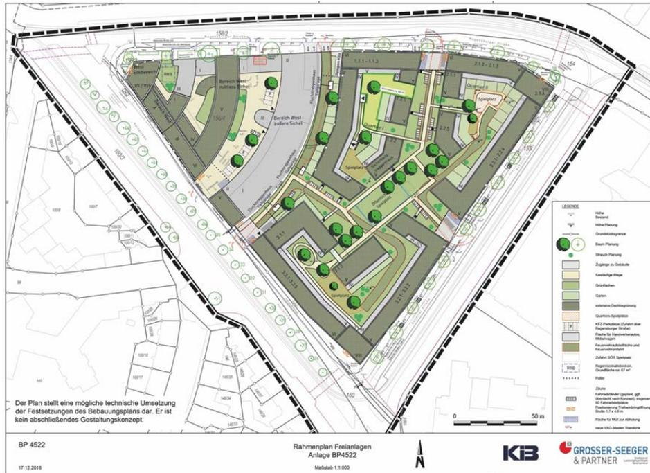
Abbildung 65 – Rahmenplan Freianlagen (Gestaltungsplan). Anlage zum Entwurf der Begründung Bebauungsplan 4522 (© KIB Gruppe 17.12.2018)
