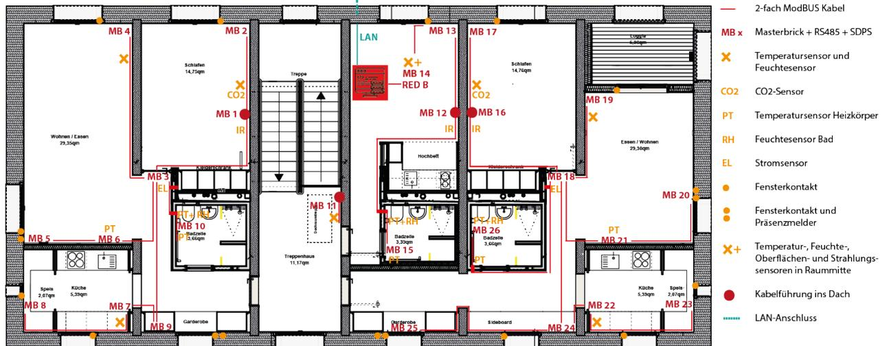
Abbildung 93 Aktueller Stand des Messplans mit Datentransfer via Modbus-Kommunikation; eigene Darstellung
