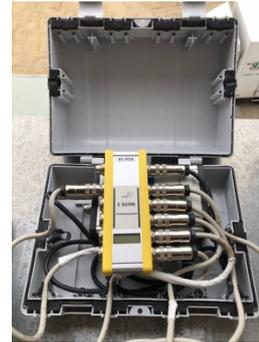
Abbildung 80: Einbaupositionen der MRE an je drei Positionen jeweils an West- und Nordwand vor der Betonage (links). Multiring-Sensorelektronik zum Loggen der Daten (rechts).
