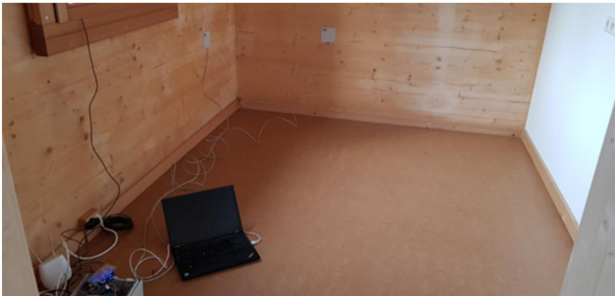
Abbildung 74: Aufbau Wärmestrommessung Massivholzgebäude, 2. Obergeschoss
