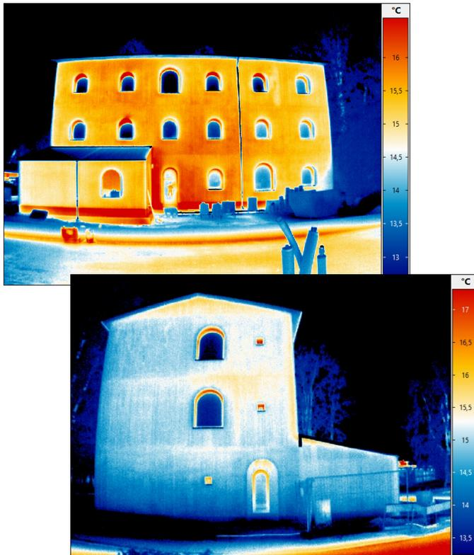
Abbildung 84: Thermographiaufnahmen mit Oberflächentemperaturen von in beiden Fällen etwa 15 °C mit unterschiedlicher Auflösung und Farbcodierung
