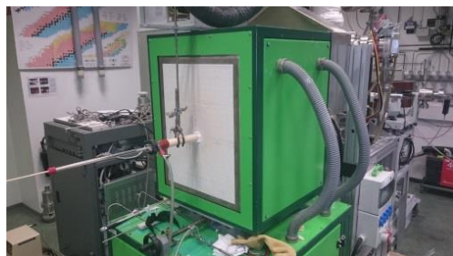
Abbildung 44: Versuchsaufbau des Vergasungsversuch mit MBMS (links) und das Pt-Schiffchen (rechts)
