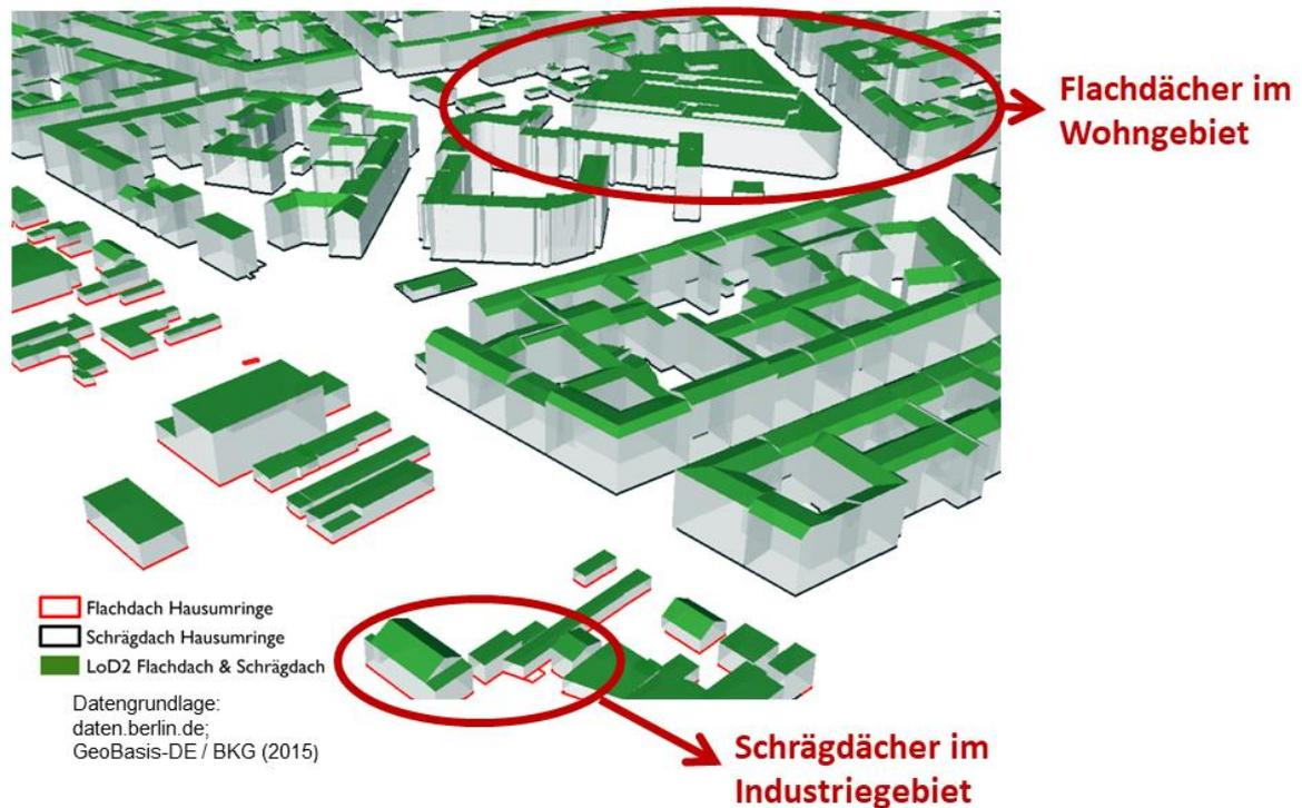
Abb. 6: Vergleich von Gebäudeumringen, die nach dem Ausgangsszenario in Schräg- und Flachdächer differenziert werden (schwarze und rote Umringe), und Gebäudetypen nach einem 3D-Gebäudemodell (LoD2 Daten) am Beispiel eines Ausschnittes von Berlin-Moabit. Grundlegendaten für die 3D-Darstellung: Berlin Partner für Wirtschaft und Technologie GmbH (2019).
