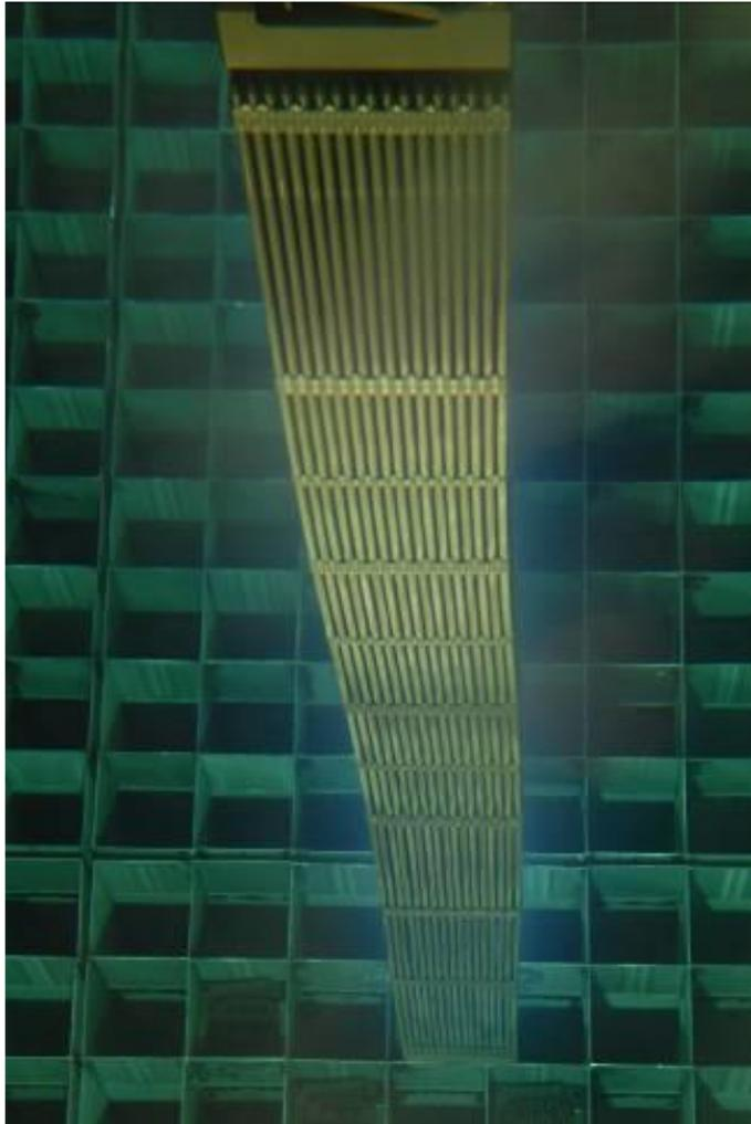
**Abb. 3.1** Beispielhafte Verformung eines DWR-Brennelements (Typ AFA), wie sie schwerpunktmäßig während der 90er Jahre beobachtet wurde /BIR 12/
