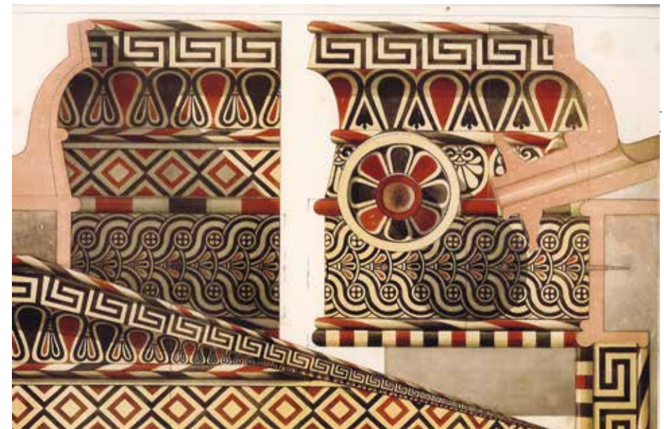
Rekonstruierte Ansicht des tönernen Dachrandes (Höhe 28,5 cm) am Schatzhaus der sizilischen Stadt Gela in Olympia. Im Schnitt ist gut zu sehen, wie die einzelnen Teile auf die Grundfläche aus Holz oder Stein genagelt waren.
