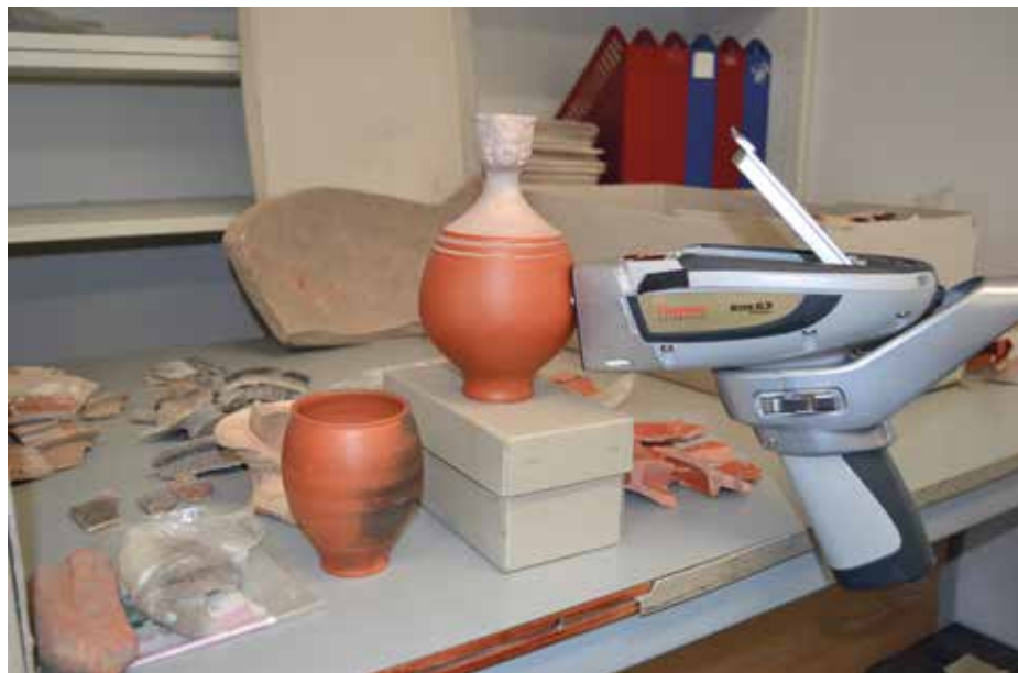
Projekt »Herkunftsbestimmungen zu den Terrakottadächern der Schatzhäuser in Olympia«: Ein portables Spektrometer während der Messung an Gefäßkeramik. Dabei ist entscheidend, dass ohne Beschädigung des Objekts unmittelbar an gereinigten Oberflächen gemessen werden kann.
