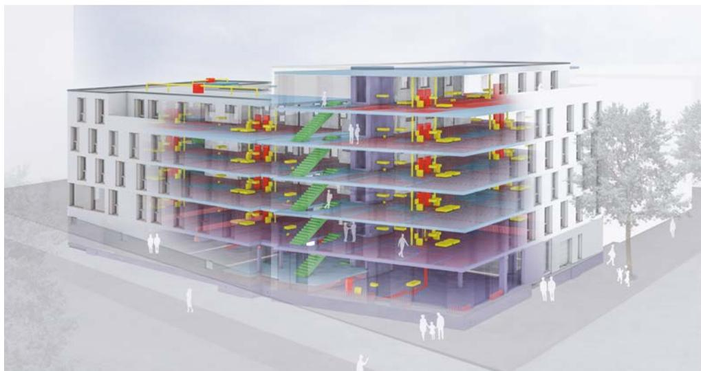
**Abb. 164** Am dreidimensionalen Modell wurde von allen Fachplanern integral geplant, sodass alle wesentlichen Detailfragen bereits vor Baubeginn geklärt werden konnten. [© Schulze Schulze Berger]
