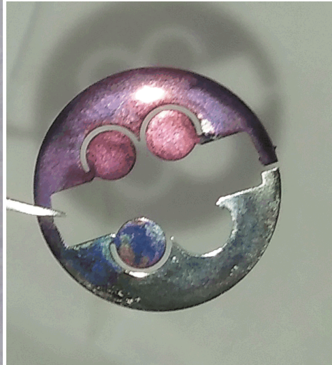
(d) COSY_16MeV sample oxide layer
