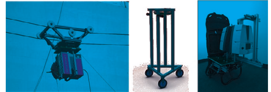
Abb. 8: Verschiedene Varianten der Trägerplattform für den Laserscanner: Seilschlitten, Rollwagen und Rückentrage
