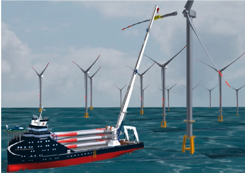
Abb. 3: Rotorblatttausch Offshore mit INNOSHIP, semi-gejackt (Bild: INNOVEN)
