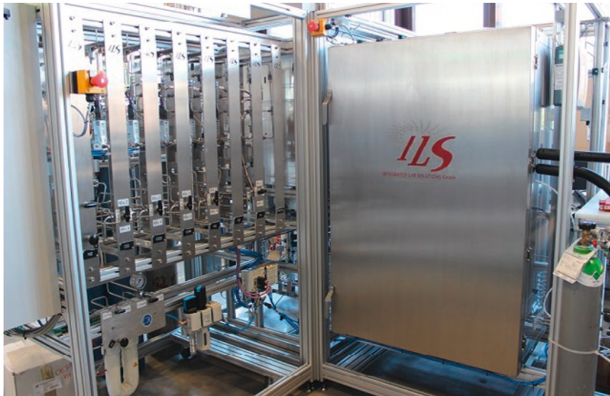
Abb. 2: Katalysatorteststand zur Bestimmung des Methanumsatzes.
