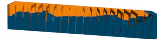
Abb. 18: RANSE CFD Simulation von Sloshinglasten in einem FLUME®-Rolldämpfungstank
