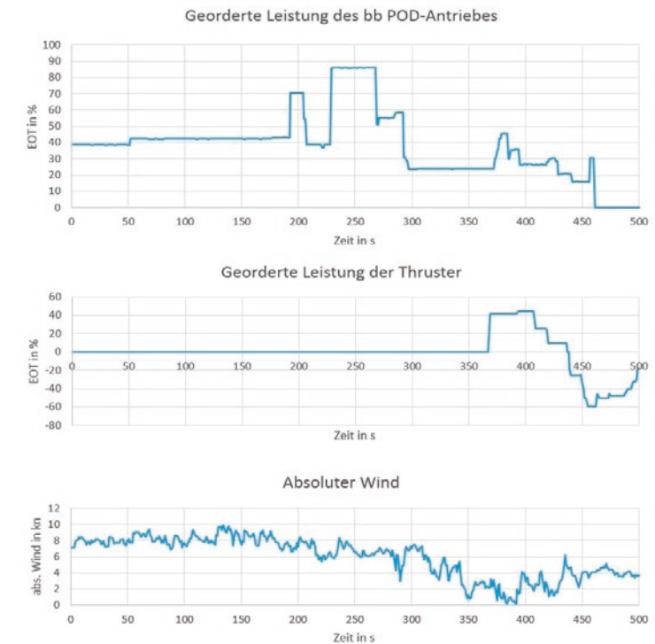
Abb. 7: EOT Verlauf für den Backbord POD, EOT für die Thruster und die Stärke des absoluten Windes während der Fahrt der Fähre „Berlin“ zum Liegeplatz im Hafen Rostock.
