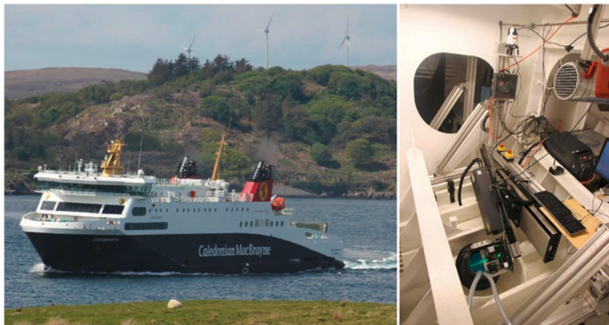
Abb. 11: Full-scale Nachstrommessungen – RoPax Fähre „Loch Seaforth“ mit Hybrid-Antrieb und Beobachtungsfenstern (links), Laseraufbau des PIV – Messsystems / Kameraaufbau – installiert im Hintergrund im gleichen Spant (rechts)
