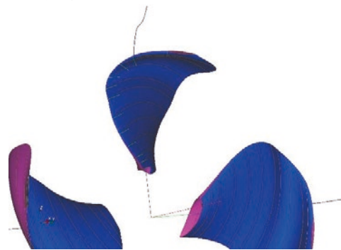
Abb. 8: Tip-Rake Propeller mit zweifach gekippten Profilebenen
