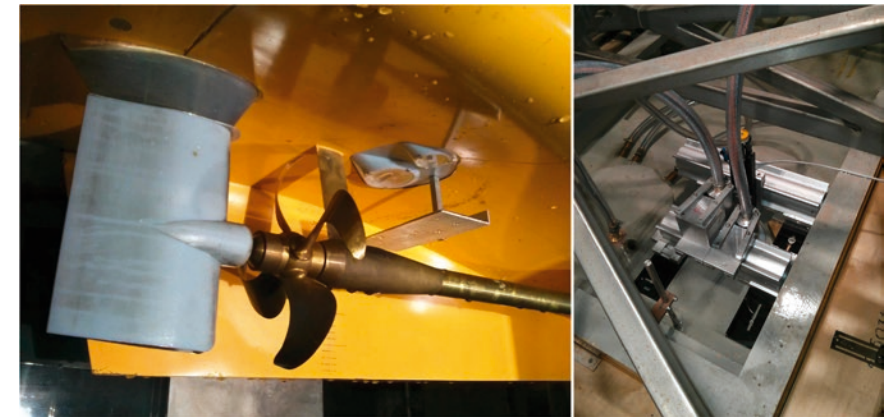
Abb. 12: Nachstrommessungen im Hykat der HSVA - Kalibriertarget unterhalb der Fensterscheiben (links), Zwei Kameras mit Kabelzuführungsschläuchen plus Target-Traversierungsachse tauchbar fixiert im Schiffsmodell (rechts)
