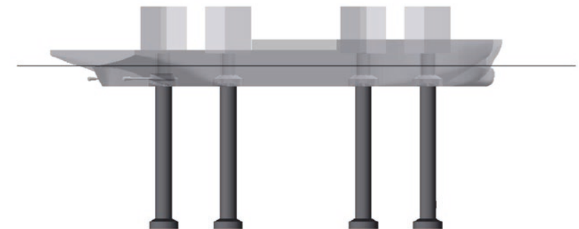
Abb. 5: Errichterschiff mit ausgefahrenen Hubbeinen
