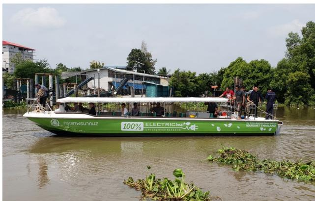
Je zwei elektrische Torqeedo-Cruise-10-kW-Außenbordmotoren, zwölf Power-24-3500-Lithiumbatterien und vier Schnellladegeräte ersetzen die früheren 205-PS-Dieselaggregate. Die rollstuhlgerecht ausgebauten Hightech-Schiffe pendeln emissionsfrei
