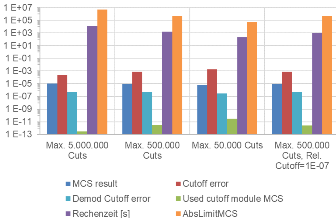
Abb. 5.38 MCS-Ergebnis und cutoff error für drei MCS-Analysen mit unterschiedlichen Einstellungen für die maximale Anzahl an cutsets und für eine MCS-Analyse, für die als Abschneidegrenzwert zusätzlich zum Absolutwert ein Relativwert (Rel. Cutoff = 1 E-07) verwendet wurde
