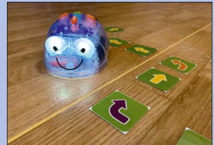
Der Blue Bot hat sieben Steuerungstasten auf dem Rücken. Damit können bis zu 200 Steuerbefehle eingegeben und gespeichert werden.
