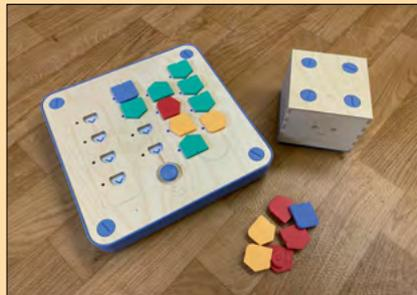
Cubetto ist ein Roboter mit zwei Rädern, die jeweils von einem Motor gesteuert werden. Um ihn zu programmieren, nutzt man sein „Brett“. Dieses besteht aus einer schlangenförmig angelegten „Warteschlange“ für eingegebene Befehle, einem Los-Knopf und einer „Funktionslinie“.
