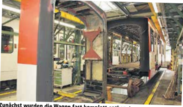
Zunächst wurden die Wagen fast komplett entkernt
