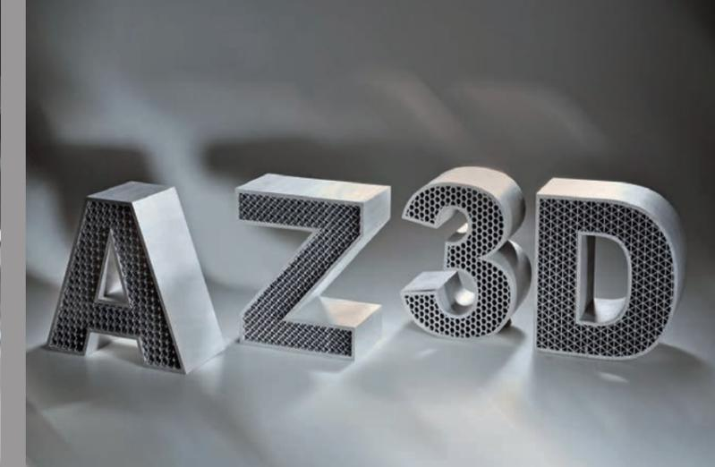
Additiv gefertigte Buchstaben mit integrierten Leichtbaustrukturen.
