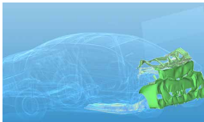
Teile mit den größten Abweichungen in zwei FE-Simulationen (Beispiel: Open-Source-FE-Modell des Toyota Yaris)
