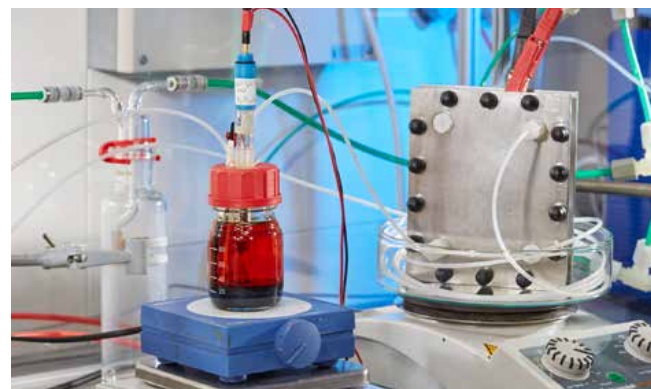
Labora Aufbau einer organischen Redox-Flow-Batterie
