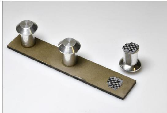
Abbildung 70: Pull-Off-Haftzugtest mit abgelöster CMC-Lage.
