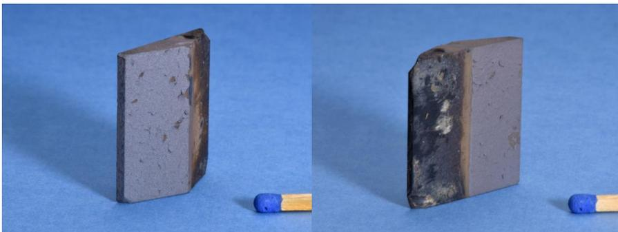
Abbildung 76: Siliziumablösungen auf den ersten beschichteten Kantengeometrien.
