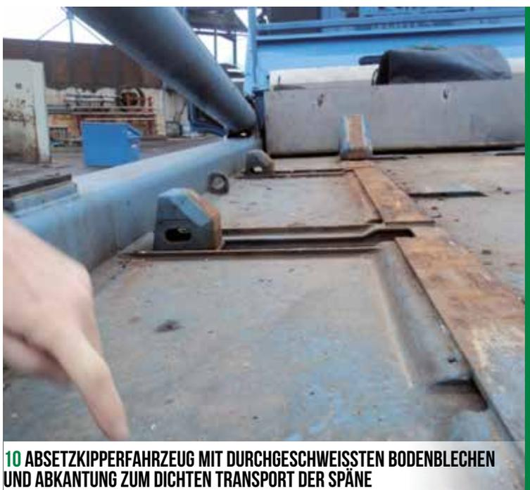
**10 ABSETZKIPPERFAHRZEUG MIT DURCHGESCHWEISSTEN BODENBLECHEN UND ABKANTUNG ZUM DICHTEN TRANSPORT DER SPÄNE**
