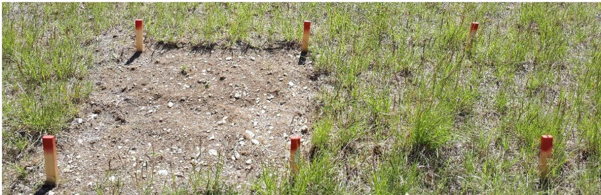
**Abb. 1: Freigelegte Erdfläche mit angrenzender Kontrollfläche, Quelle: eigene Abbildung**
