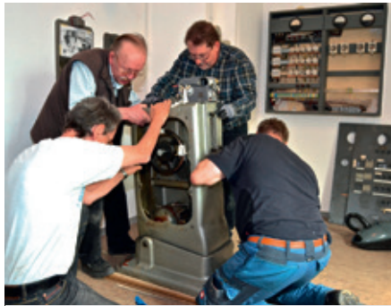
Aus dem Kino Gemünd: Der schwere Fuß vom Projektor ASKANIA AP XII - 1 „ALPHA“ wird aufgestellt
