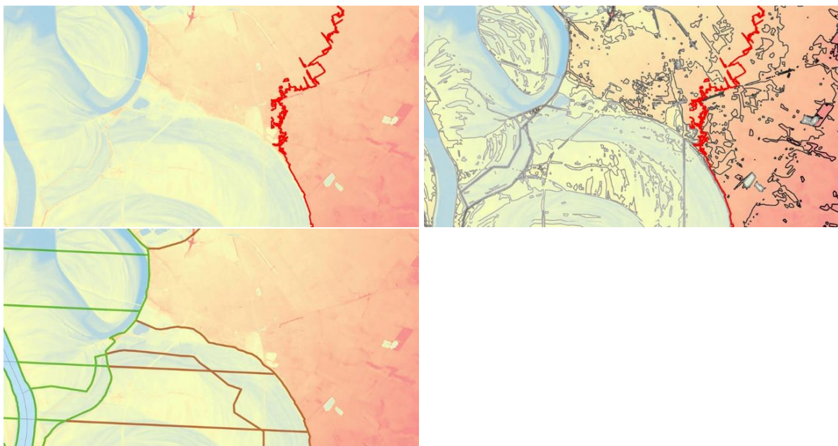
Abb. 14: DGM10 mit Überlagerung der HQ_{\text{extrem}} -Linie aus der HWRM-RL in rot (links oben) sowie mit Einblendung der neuen hydrologischen Berechnungen in m-Abständen (graue Linien) bei undeutlicher ausgeprägtem Hochufer (rechts oben). DGM10 mit Überlagerung der Auenabgrenzung 2021, rezente Aue (grün), Altaue (braun) (links unten), (Datenquelle: s. Anhang 2, Tab. 17).
