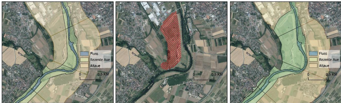
Abb. 4: Renaturierungsgebiet mit Deichrückverlegung bei Bretzenheim (Nahe), Fertigstellung 2015, links: Auenabgrenzung 2009, Mitte: Gebiet der Deichrückverlegung, rechts: Auenabgrenzung 2021 (Datenquelle: s. Anhang 2, Tab. 17).
