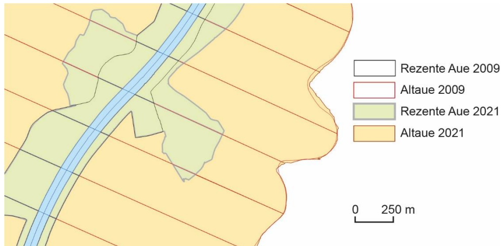
Abb. 24: Beispielhafter Ausschnitt der km-Segmente RHE-428000 bis RHE-422000, nördlich Karlsruhe, mit größerer Abgrenzung der rezenten Aue und genauerer Abgrenzung der Altaue.
