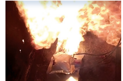
Explosion während eines Thermal Runaway einer Lithium-Ionen-Pouchzelle.
