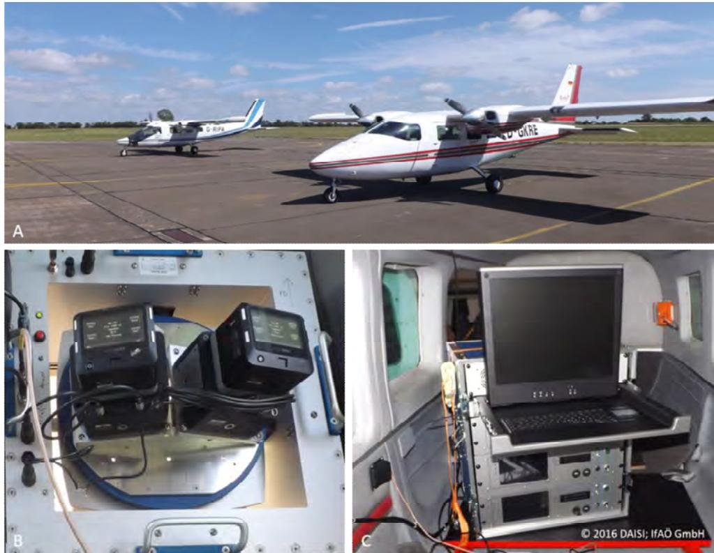
Abb. 4 A-C: A: Hochflügelige, zweimotorige Kleinflugzeuge vom Typ Partenavia P.68, mit eingebauten Kamerasystemen. B: Gyrostat mit zwei Mittelformatkameras zur Standbilderfassung. C: Energieversorgungs-, Speicher- und Kontrolleinheiten der Kameraplattform montiert im Flugzeuginneren (© 2016 DAISI; IfAO GmbH).
