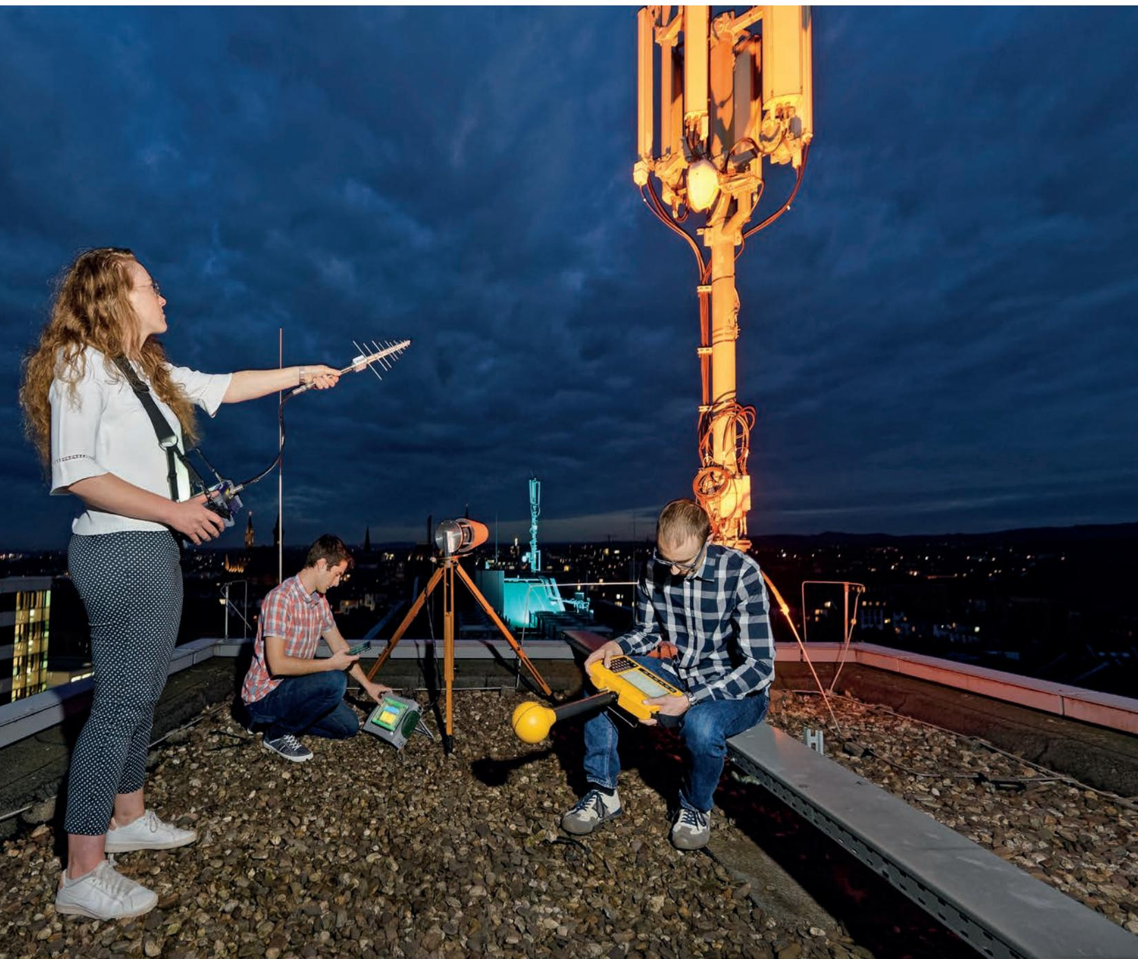
Bild 1: Durchführung einer Messung von Mobilfunkimmissionen an einem Dachstandort.
