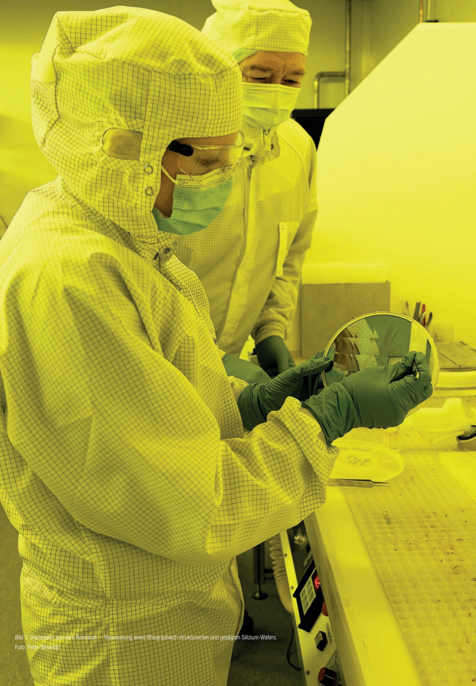
Bild 1: Impression aus dem Reinraum – Vereinzelung eines lithographisch strukturierten und gesägten Silizium-Wafers.
