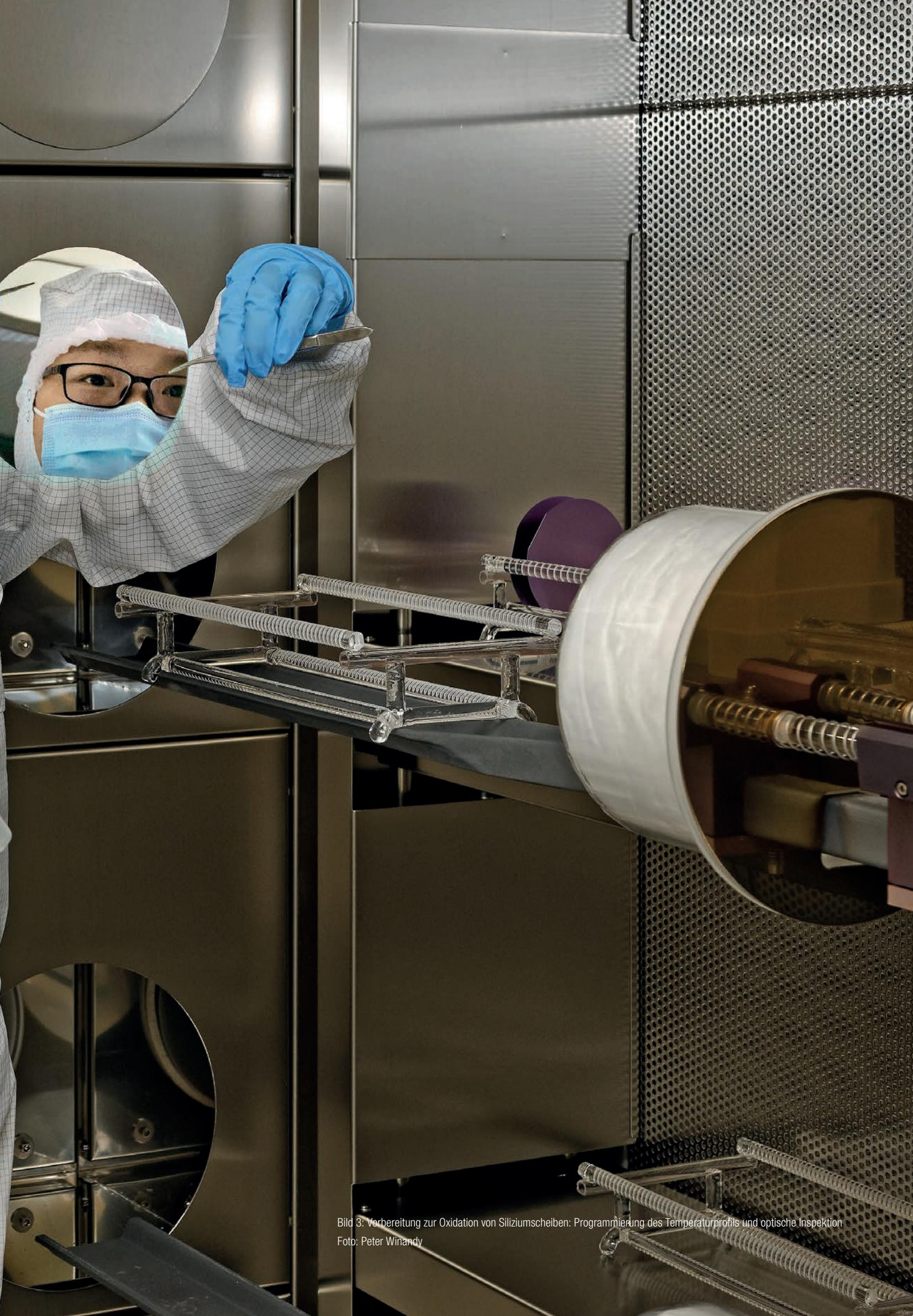
Bild 3: Vorbereitung zur Oxidation von Siliziumscheiben: Programmierung des Temperaturprofils und optische Inspektion
