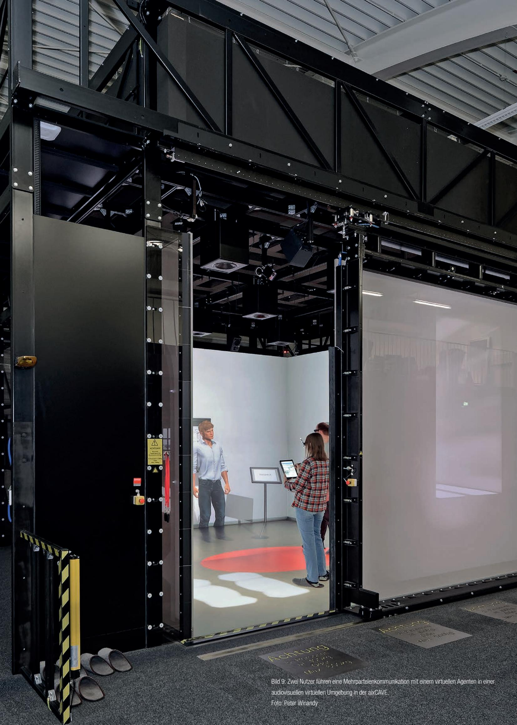
Bild 9: Zwei Nutzer führen eine Mehrparteienskommunikation mit einem virtuellen Agenten in einer audiovisuellen virtuellen Umgebung in der aixCAVE.
