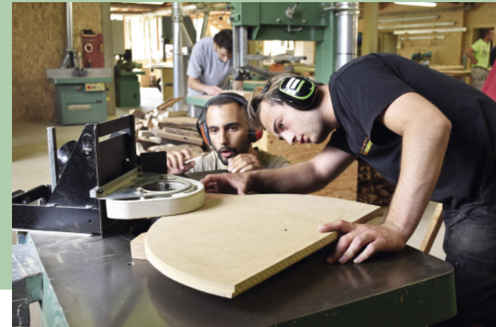
Anlaufringfräsen unter französischer Assistenz: Die Scha- blone überträgt die Außenkontur der Kreissegmente für die Hockerplatte
