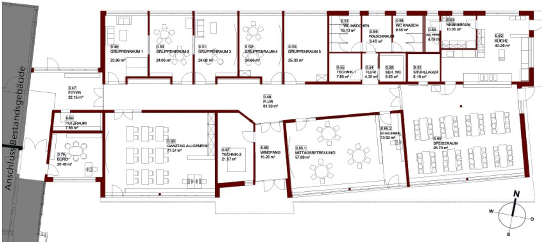
Abbildung 65: Erdgeschoss-Grundriss des Erweiterungsbaus
