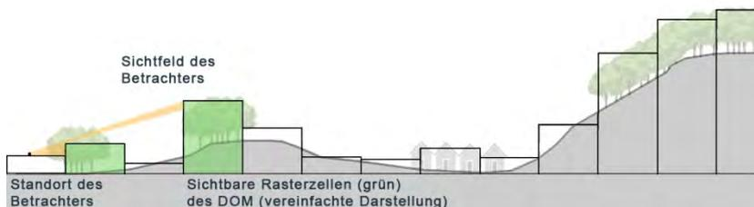
Abb. 70: Schematische Darstellung der Unterschiede zwischen den Sichtfeldanalysen mit einem DGM und einem DOM
