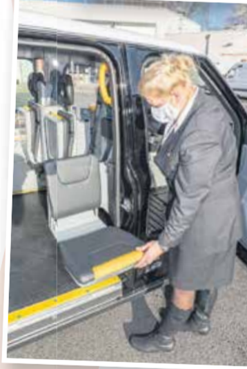
Oben: Aufladen der Batterie; unten: Die Wagen verfügen über einen nach außen schwenkbaren Sitz
