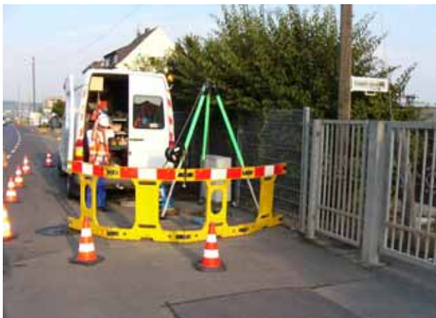
Kalibrierung von Abflusssdrosseln an einem unterirdischen Speicher
