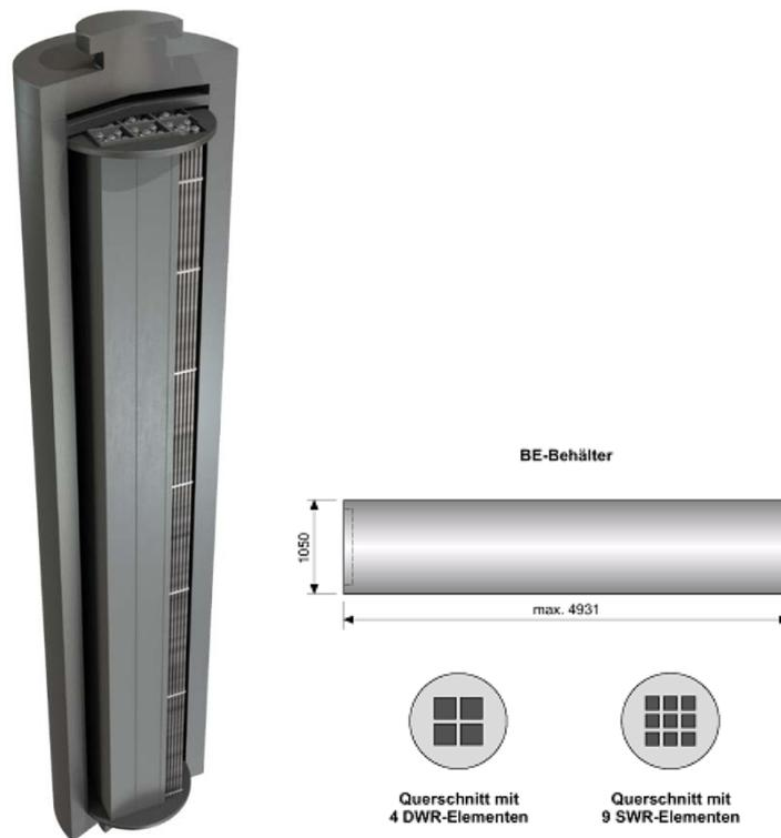
**Abb. 2.9** Stahlbehälter für abgebrannte Brennelemente /NAG 17c/, /PAT 12/
