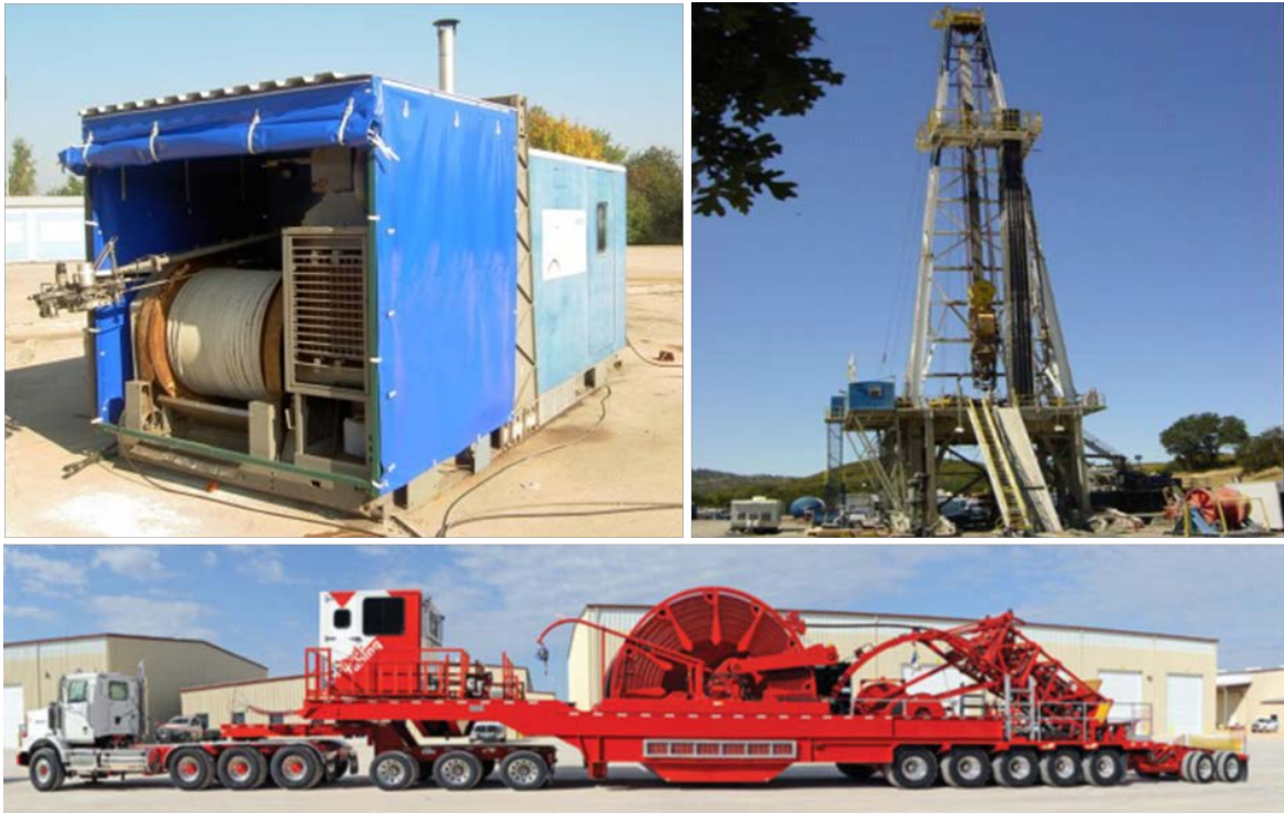
Abb. 2.7 Einbringungs- und Rückholungsverfahren mit Kabelwinde (links, oben), Coil Tubing Unit (mitte, unten) und Gestänge durch einen Bohrturm (rechts, oben)
