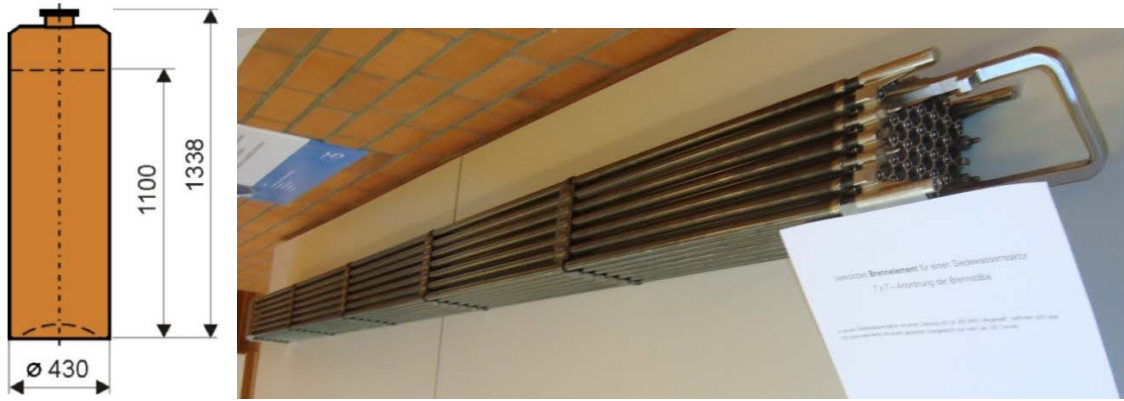
Abb. 2.2 HAW-Kokille nach /THO 09/ und Brennelementmuster (eigene Aufnahme)
