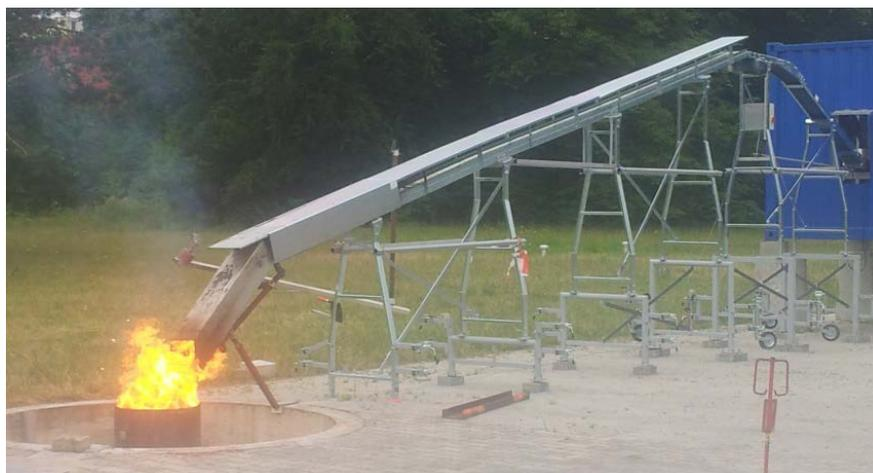
**Abb. 2.106** MOCKA-Anlage mit Versuchstiegel (links im Bild), in dem die Wechselwirkung der Schmelze mit Betonstrukturen stattfindet, sowie der Zufuhreinrichtung für chemisch reaktives Material (portioniertes Thermit-Pulver auf Fe/Al-Basis, Zr). Bildquelle: KIT
