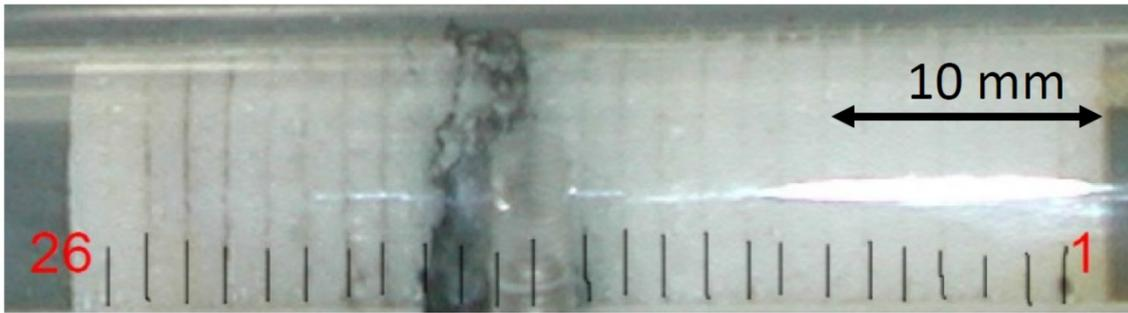
**Abb. 6.2** Poröses Medium nach 76 Tagen des Gegendiffusionsversuches /SEH 05/
