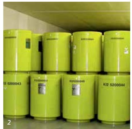
(1) Für das niederländische Kernkraftwerk Borssele entwickelte die GRS unter anderem einen Analysesimulator für Stör- und Unfälle. (2) MOSAIK®-Behälter für die Zwischenlagerung und den Transport von mitteldioaktiven Abfällen mit vernachlässigbarer Wärmeentwicklung, die zukünftig im Schacht Konrad endgelagert werden sollen.
