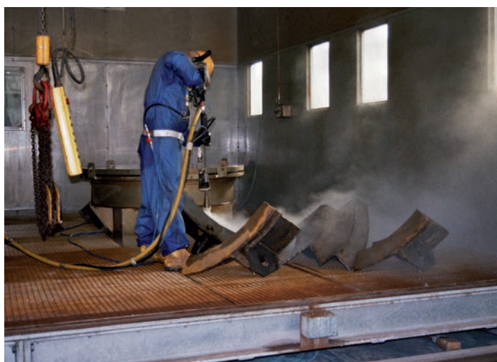
Abb. 26: Dekontamination mit Wasserstrahl
