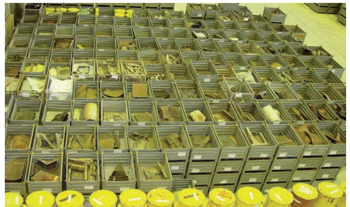
Abb. 33: Gitterboxen mit vorsortierten Reststoffen zur Freigabe
