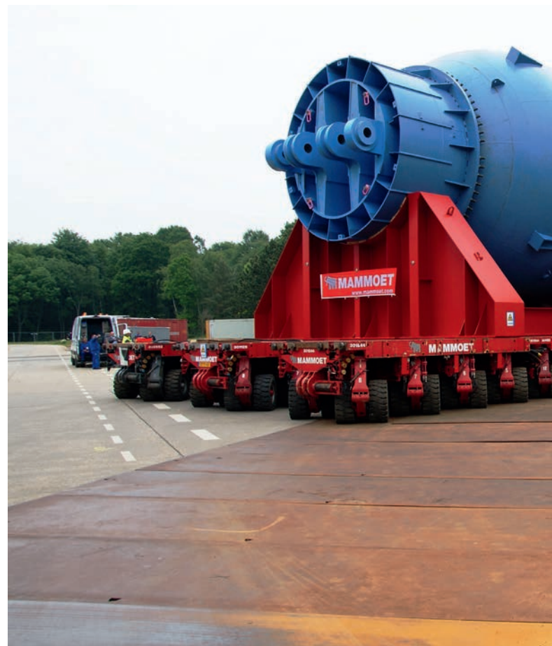
Abb. 47: Transport des AVR-Reaktorbehälters zum Zwischenlager
