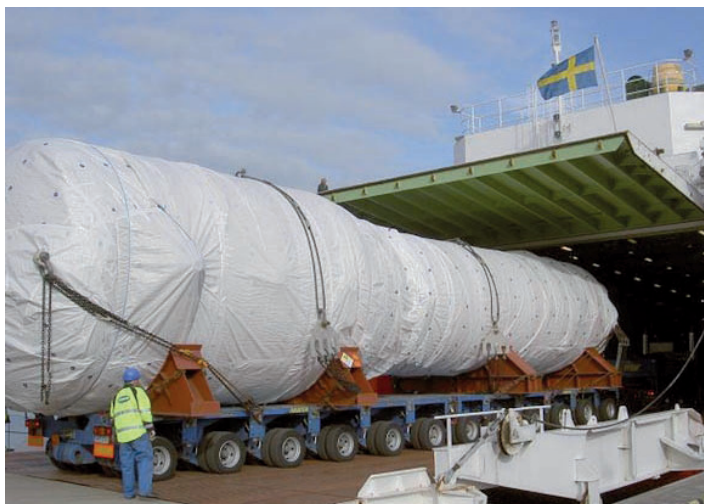
Abb. 30: Transport eines Dampferzeugers nach Schweden zum Einschmelzen
