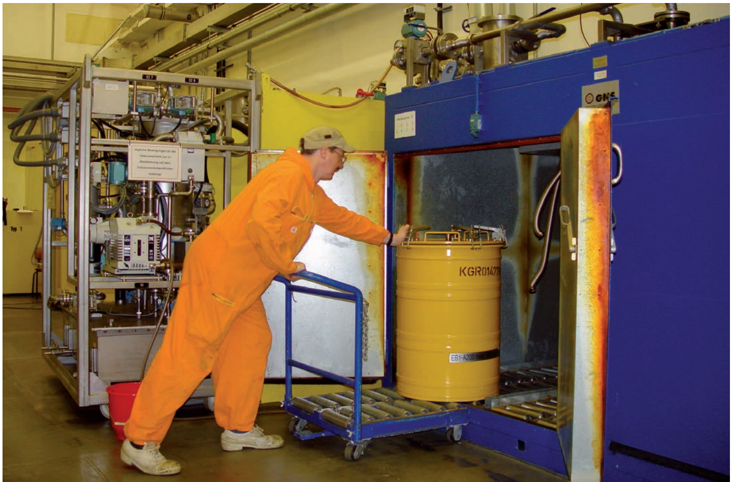
Abb. 41: Konditionierung von Abfällen (Fasstrochnungsanlage)
