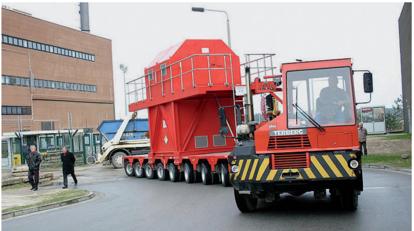
Abb. 21: Innerbetrieblicher Transport bestrahlter Brennelemente
