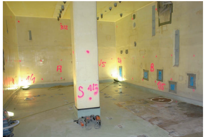
Abb. 36: Raum mit Markierungen zur Bestimmung der Oberflächenkontamination
