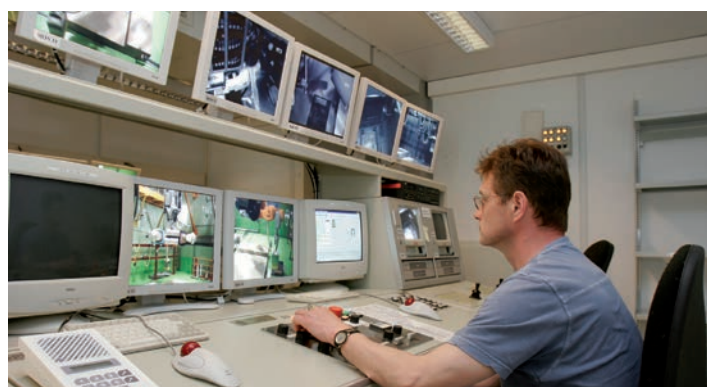
Abb. 29a: Steuerstand für fernbediente Arbeiten
