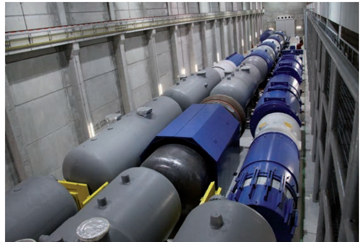
Abb. 40: Abklinglagerung von Großkomponenten im Zwischenlager Nord
